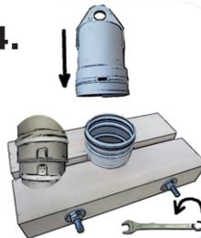
Verbinden Sie die Hebemuffe und das Steigrohr durch die Drahtspirale. Achten Sie bei dem Aufsetzen auf die Dreh-sicherung. Nach dem Einschieben der Spirale heben Sie die Leitung ein wenig an und entfernen Sie das Holzbündel. Die Steigleitung kann nun um die nächste Rohrlänge angehoben werden.
