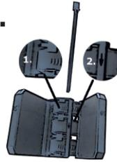
Stecken Sie die Laschen eines Segmentes in die Öffnungen des nächsten Segmentes. Verbinden Sie Beide indem Sie den Keil in Pfeilrichtung einschieben. Der Keil muss mindestens bis zur unteren Seite der Kufe eingeschoben sein.
